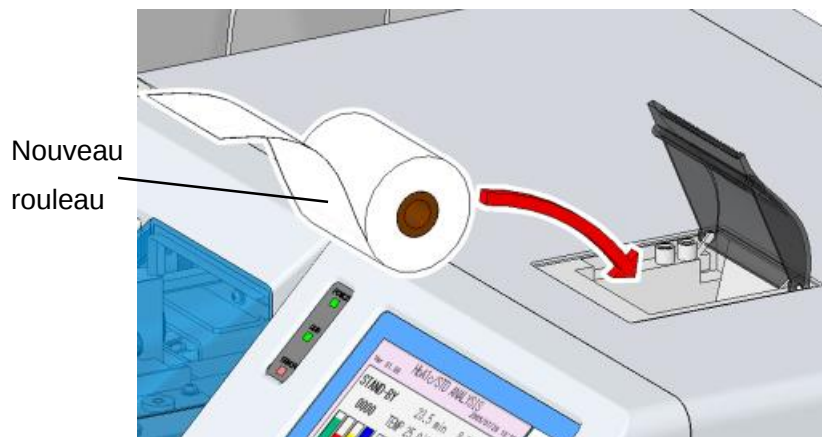
Fig. 5-3 Installation d'un nouveau rouleau
