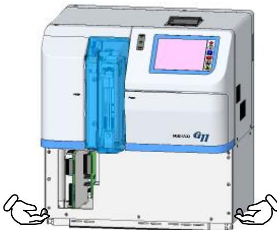
Fig. 2-6 Endroits où saisir l'appareil pour le déplacer
